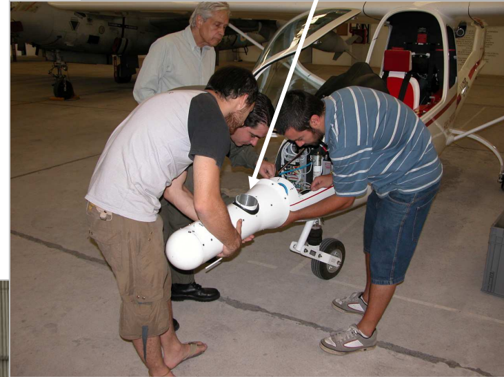
MONTAJE DE LA NARIZ
